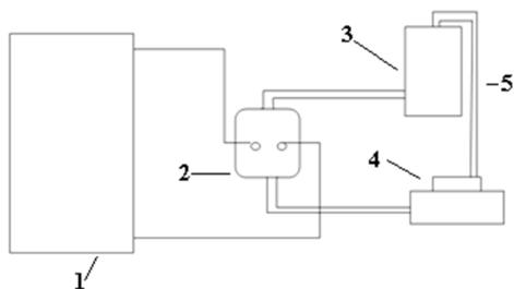
Рис. 1. Схема устройства для электроразрядной кавитационной обработки сока растений: 1 – генератор импульсов электрического тока (ГИТ); 2 – разрядная камера; 3 – емкость; 4 – насос; 5 – трубопровод
