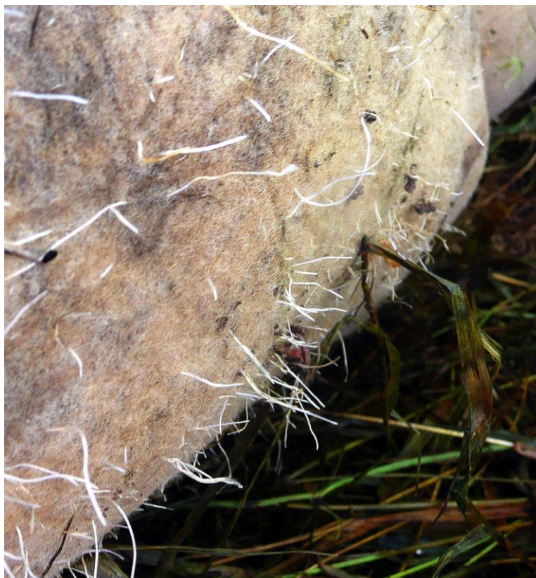
Рис. 2. Ликвидация зарослей борщевика с применением геополотна. Корни злаков прорастают сквозь геополотно и прочно фиксируют его на поверхности земли.
